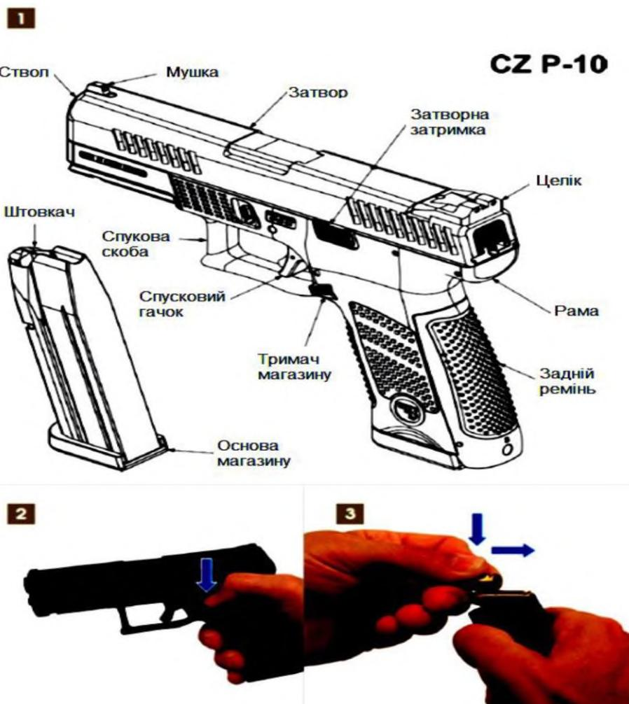
Рисунок 6.2 – Складові частини та порядок заряджання
