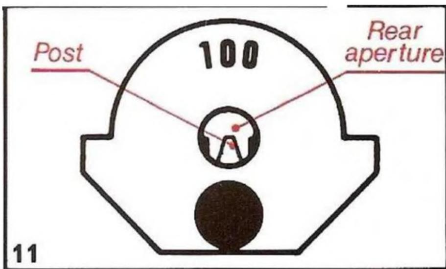
**Рисунок 4.14 – Порядок прицілювання**
