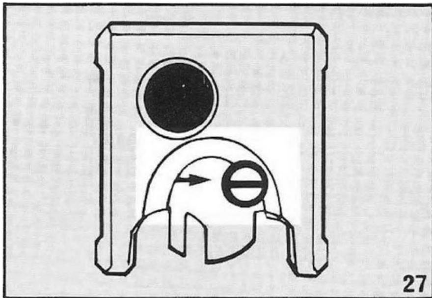
**Рисунок 4.29 – Порядок встановлення екстрактору у затворі**
