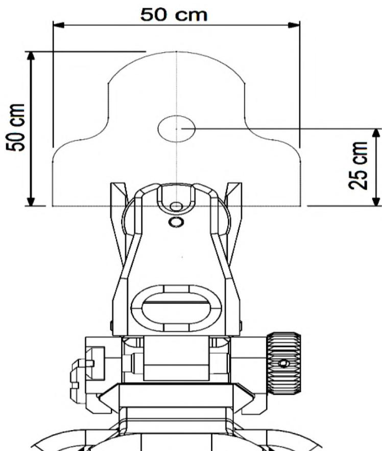
**Рисунок 2.51 –** Прицілювання на дистанції 100 м
