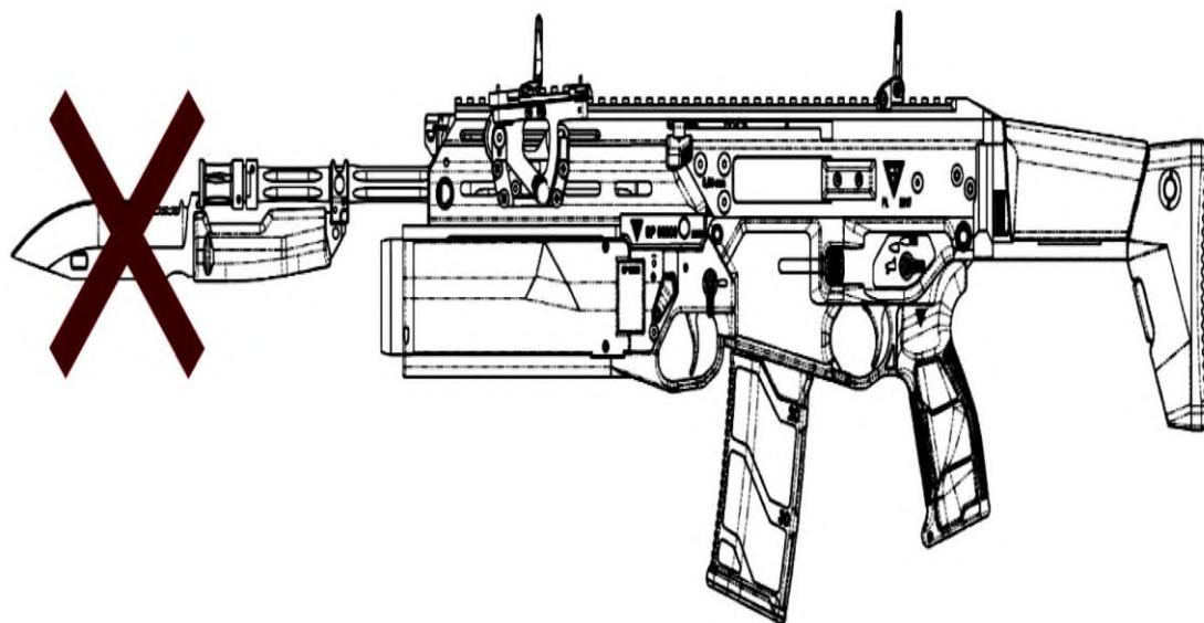
Рисунок 2.45 – Карабін з прикріпленим гранатометом і багнетом –
