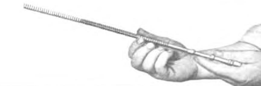
**Рисунок. 5.26 – Відокремлення пружини поршня від штока поршня**
