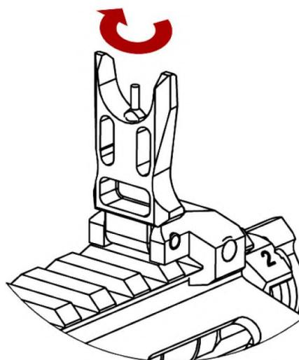
**Рисунок 2.49 – Регулювання мушки (вкручування)**
