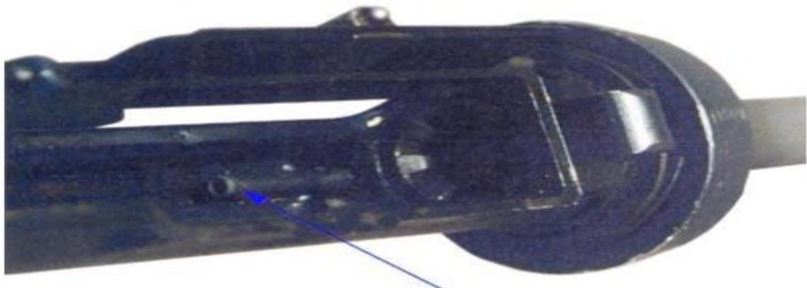
**Рисунок 1.7 – Задня частина газовідвідної трубки**
