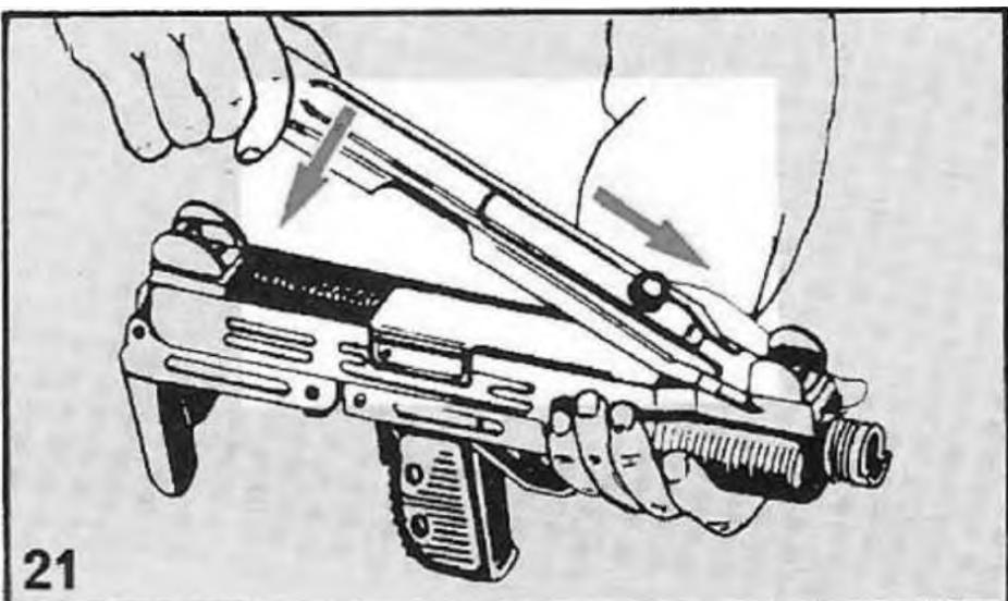
**Рисунок 4.25 – Порядок збирання затвора та зворотньої пружини**
