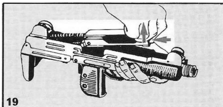
**Рисунок 4.23 – Порядок вилучення затвора і зворотньої пружини**
