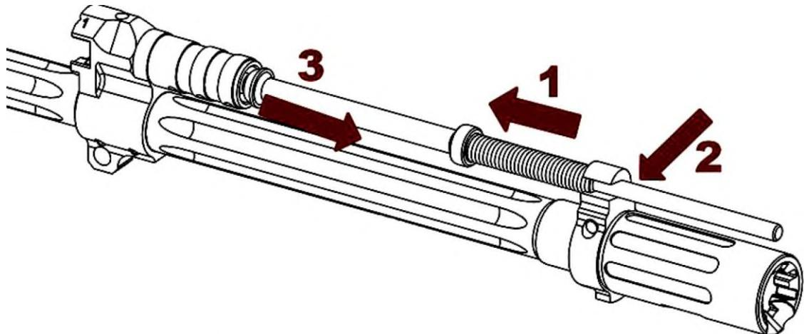
Рисунок 2.33 – Відокремлення штовхача та зворотної пружини
