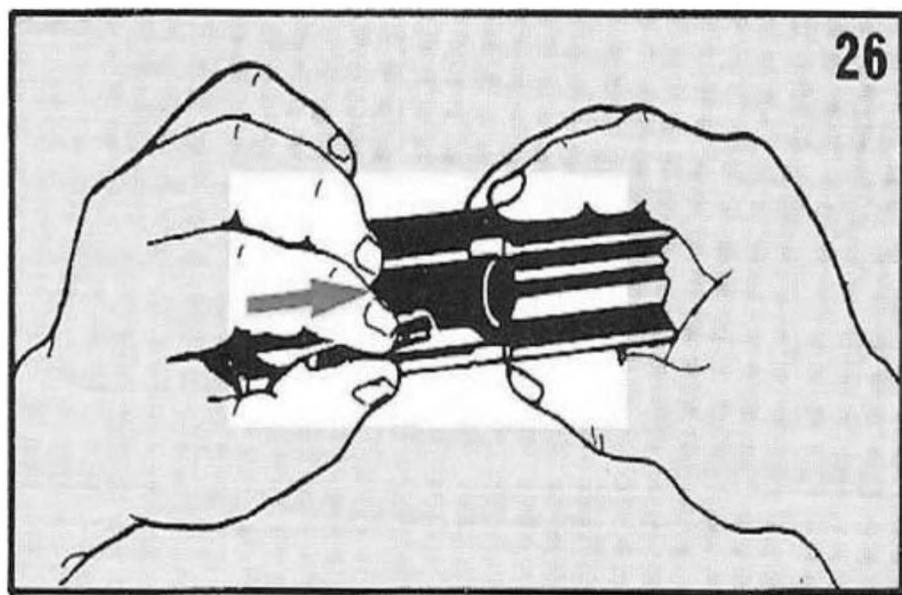
**Рисунок 4.28 – Порядок встановлення екстрактору на своє місце**
