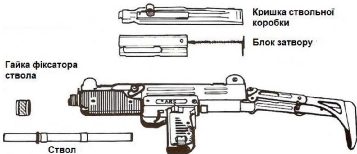
**Рисунок 4.18 – Вигляд зброї після неповного розбирання**
