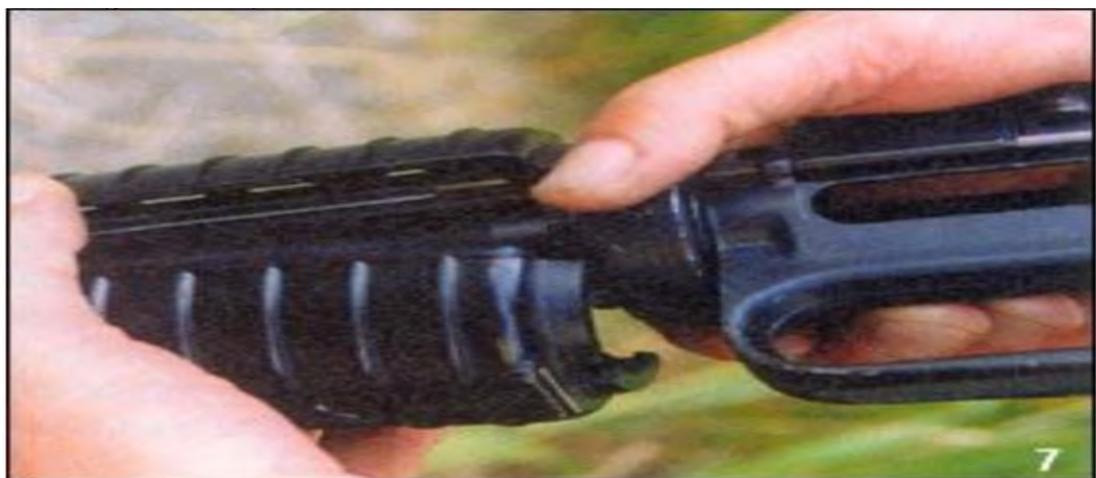
**Рисунок 1.16 – Відокремлення накладки цівки**
