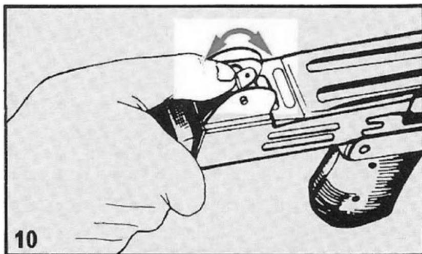
**Рисунок 4.13 – Встановлення цілика на необхідну дальність**
