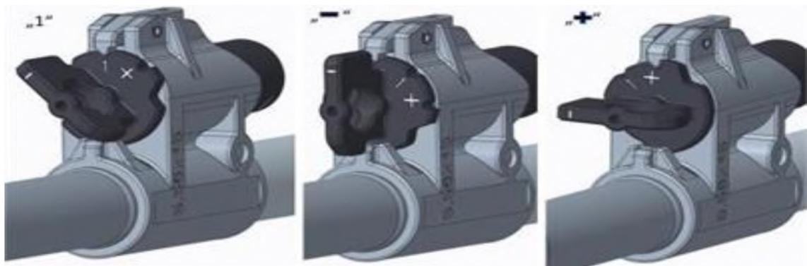
**Рисунок 7.5 – Положення газової трубки для кал. 7,62x39**
