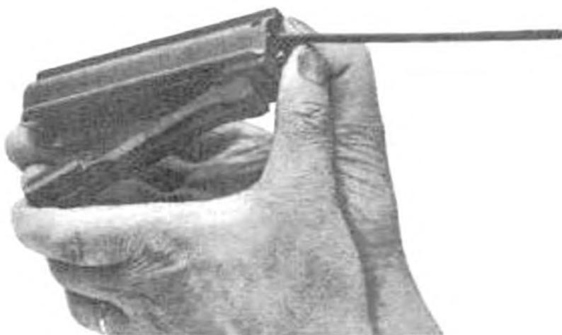
**Рисунок. 5.20** – Від'єднання передньої частини казенника від затвора
