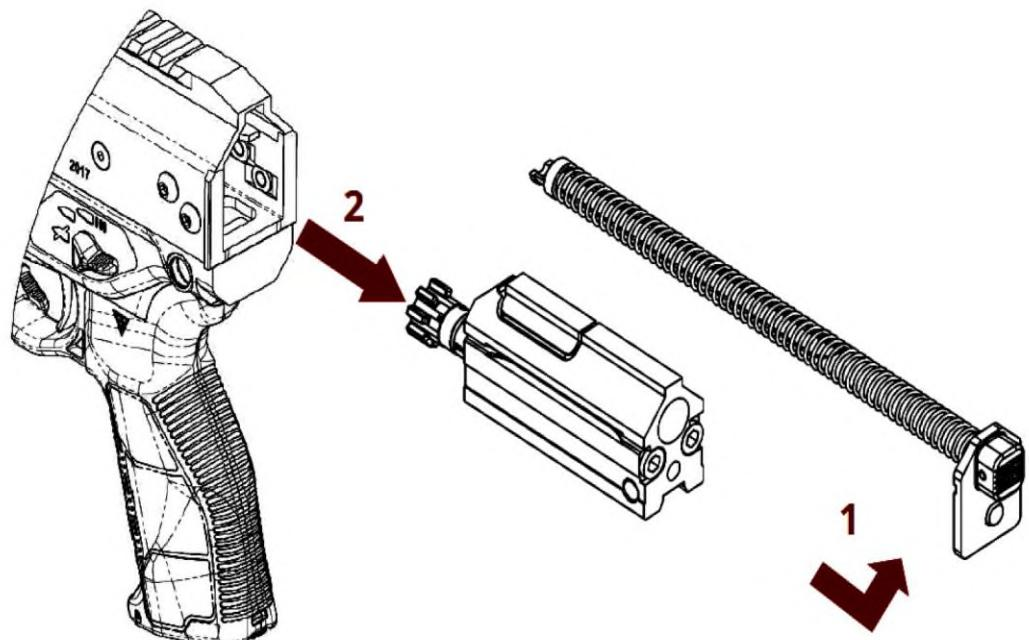
Рисунок 2.28 – Демонтаж зворотного механізму та рухомого вузла
