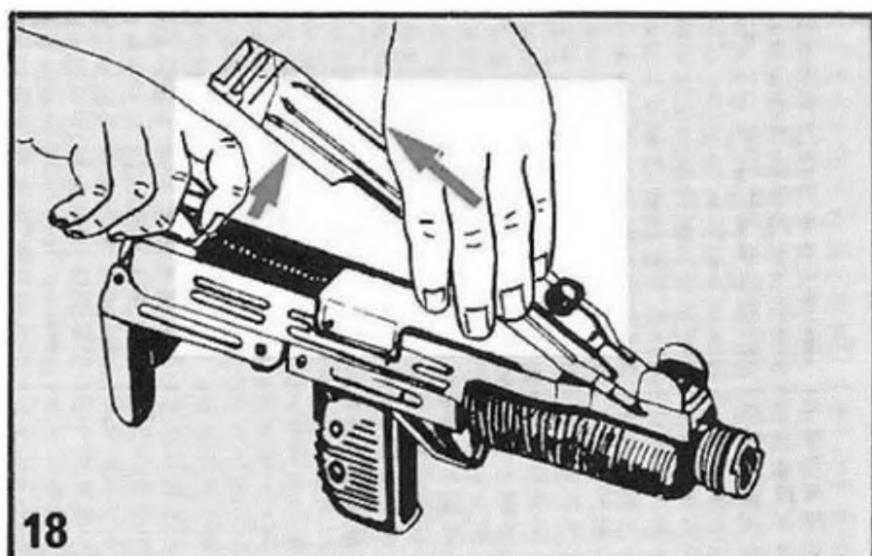
**Рисунок 4.22 – Порядок зняття кришки ствольної коробки**
