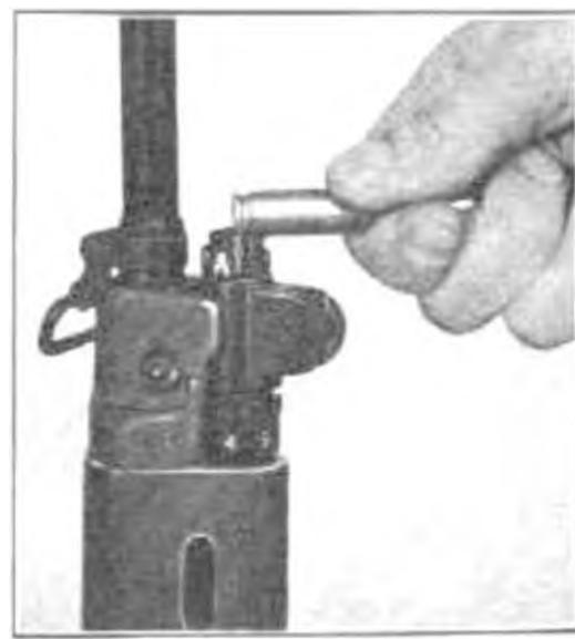
**Рисунок. 5.24 – Зняття газової пробки за допомогою патрона**
