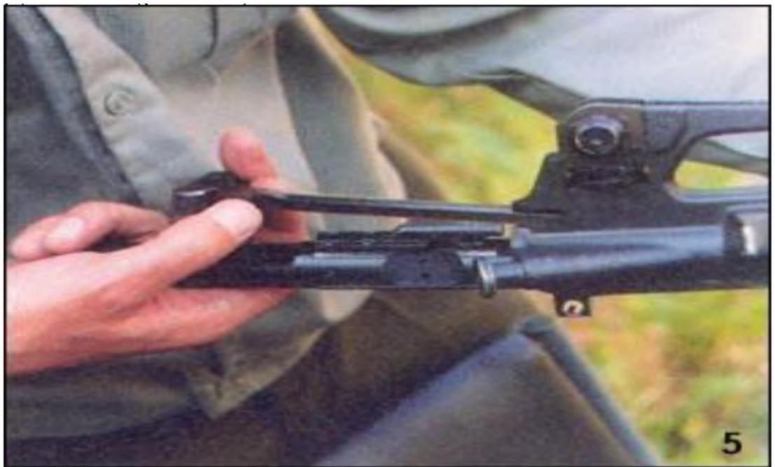
**Рисунок 1.14 – Вилучення стебла затвору та планки перезарядження.**
