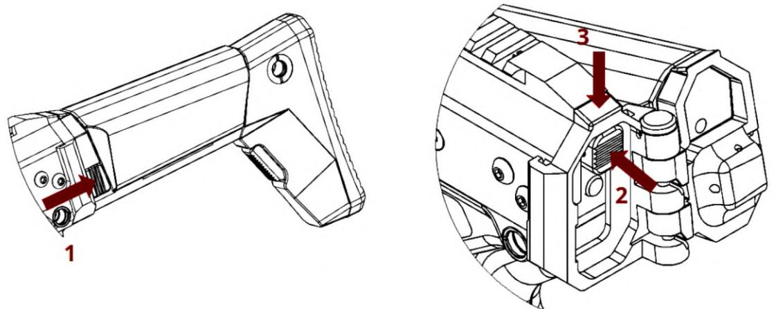
Рисунок 2.27 – Демонтаж прикладу
