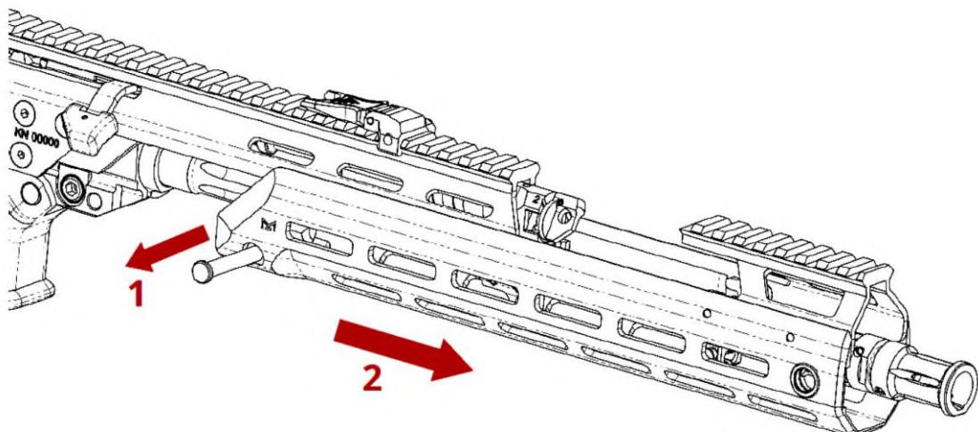
Рисунок 2.25 – Від'єднання ців'я від затворної коробки
