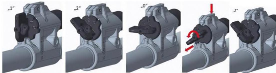
Рисунок 7.4 – Положення газової трубки
