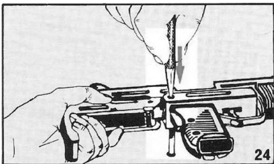
**Рисунок 4.30 – Порядок від'єднання штифту пістолетної рукоятки**
