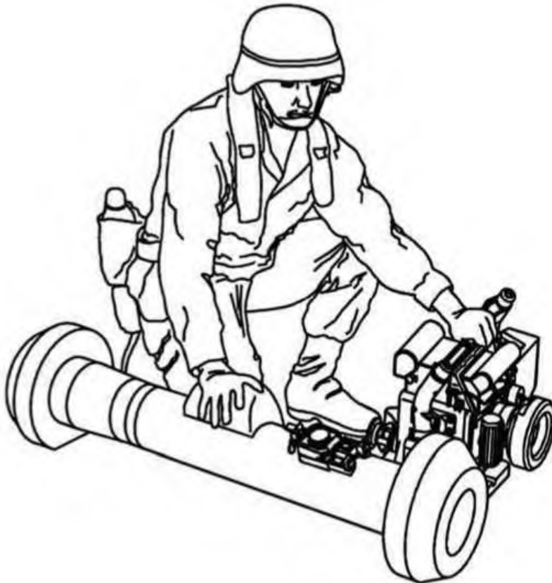
Рисунок 6.39 – Приєднання дисплею командного запуску CLU до Javeline
