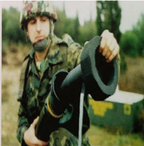
Рисунок 3.5 – Вилучення передньої захисної кришки
