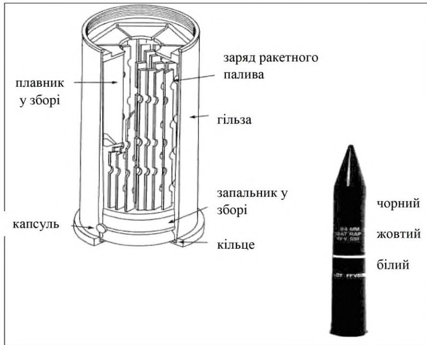
Рисунок 4.2 – Корпус картриджа у зборі FFV 551 з колірним кодом
