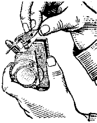
Малюнок 19 - Приєднання спускового важеля електроспуску
