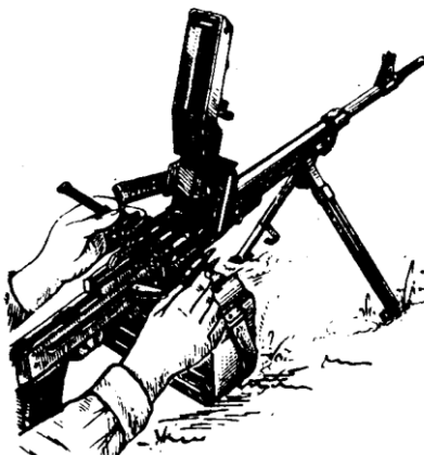
Малюнок 81- Вкладання стрічки в приймач
